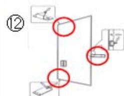
⑫ サイドドアの作動状況が悪い場合は自動車用シャックリッス可動部に注入する (CRC-556は使用しないで下さい)
