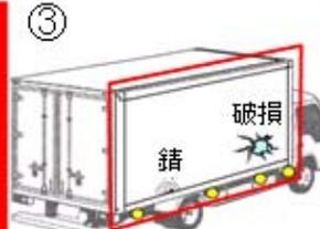
③ 右側サイト面体 錆、破損などの確認
