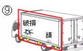
⑨ 左側サイト面体 錆、破損などの確認
