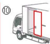
⑩ サイドドアのガスケットの破れ・はがれなどの確認
