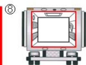
⑧ 内装部品に外れ、損傷などの確認
