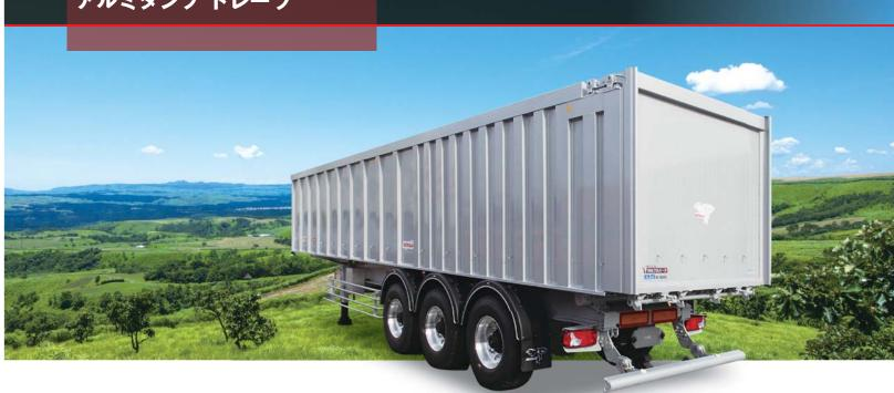
テレスコピックシリンダー、ボディ及びシャシにアルミ合金を採用、 最大積載量29.8tを達成!(3軸車)
