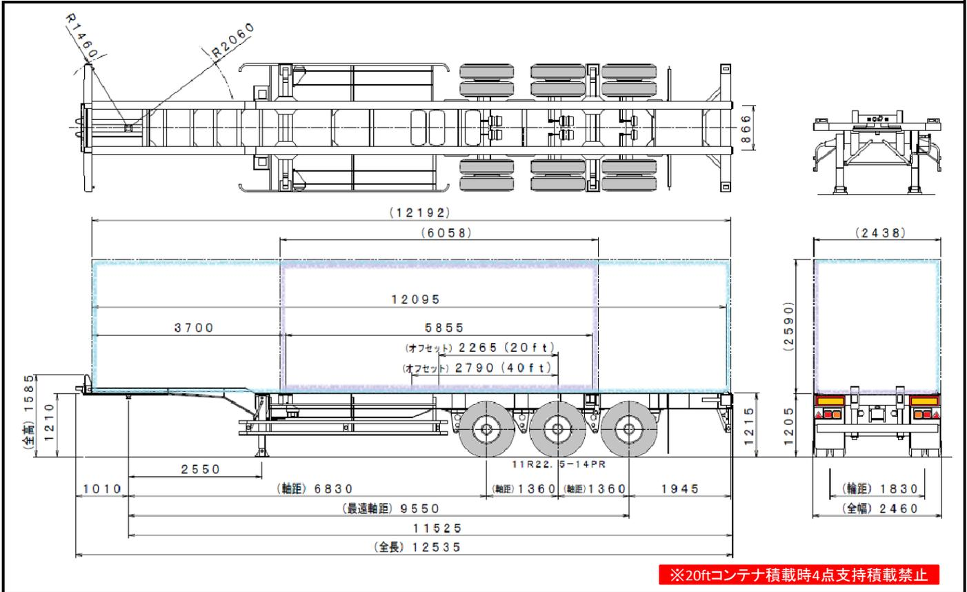
※20ftコンテナ積載時4点支持積載禁止
