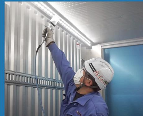
プレミアムフルハーフコートの施工の工程。スプレーガンで庫内の壁や天井、床などに塗布する
